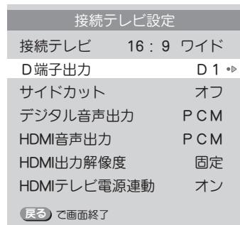
接続するテレビの D 映像入力に合わせて D1/D2/D3/D4/1125i の中から ◀▶ ボタンで選びます。
